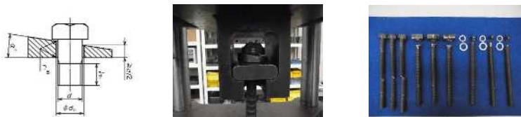
図-くさび引張試験による破断位置確認
